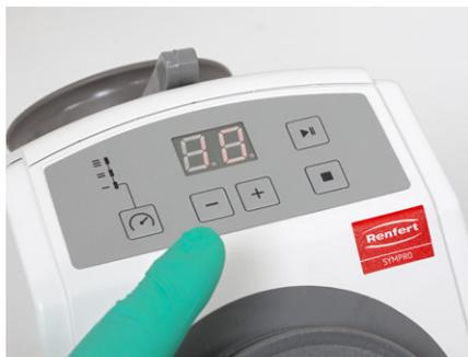
Fig. 4: pannello di comando a membrana di SYMPRO Foto: Renfert GmbH
