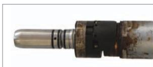
Se il disinfettante penetra nello strumento o nell'attacco del motore/della turbina, possono verificarsi guasti dell'attacco e del motore.
