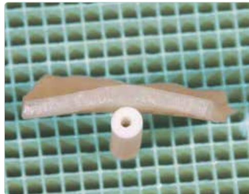
Risultati dopo la quinta cottura (770°C 1min, mantenimento). Test condotto da Masayuki Hoshi, RDT.
