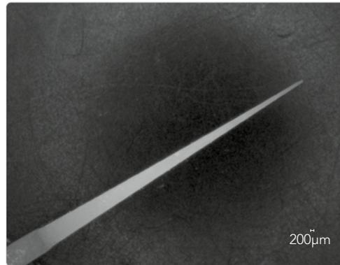
Simulando il margine, il campione con il bordo è stato cotto ripetutamente. Nessuna deformazione o rottura dopo cotture multiple.
