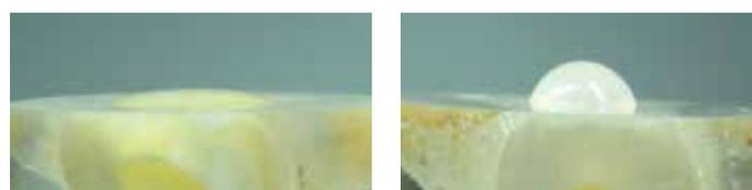
Fig. 15: Goccia d'acqua su 3M™ Scotchbond™ Universal Plus adesivo. Sinistra: non polimerizzato, asciugato con getto d'aria (basso angolo di contatto) / Destra: polimerizzato, strato inibito dall'ossigeno rimosso (alto grado di contatto). Substrato: dentina bovina. (Dati interni 3M, non pubblicati)
