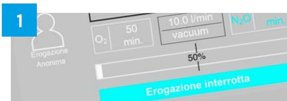
Quando la pressione della bombola di ossigeno va a zero (assenza di ossigeno), si interrompe automaticamente l'erogazione del gas protossido di azoto.
