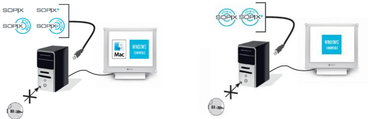
**AVVERTENZA:** Non collegare mai il cavo USB alla porta presente sul lato anteriore del computer. Di fatto, i connettori presenti facciata sul lato anteriore del computer sono molto più sensibili ai vari tipi di interferenze del segnale USB e ciò può portare a un malfunzionamento del sistema di radiologia digitale.
