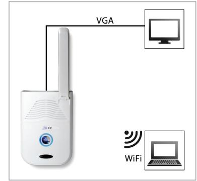
Le immagini vengono visualizzate nel monitor del riunito collegandolo con la centralina della telecamera tramite il cavo VGA in dotazione. Il trasferimento delle immagini da centralina a PC, invece, è senza fili: tramite una semplice configurazione WiFi le immagini vengono visualizzate sul PC, evitando il passaggio del cavo all'interno del palo lampada del riunito.
