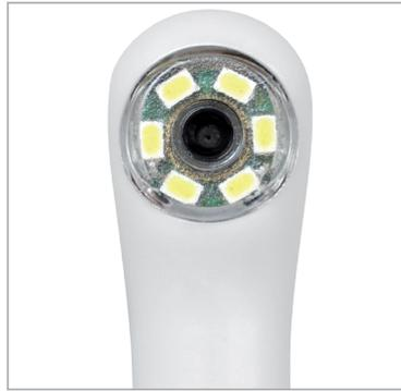
L'illuminazione avviene tramite 6 LED che generano meno calore e utilizzano minore energia in quanto non necessitano di raffreddamento. Inoltre, la manutenzione, richiesta dai vecchi sistemi a fibre ottiche, non sarà più necessaria. L'illuminazione dei LED e il sensore 1/4" Sony CCD alta sensibilità con funzione autofocus rendono l'immagine definita, nitida, quasi reale.
